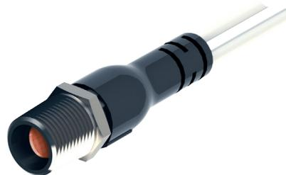
Der Temperatursensor der TM-950-Serie nutzt eine einzigartige Quarzglas-technik, mit deren Hilfe ein hermetisch verschlossenes Gehäuse erzeugt wird. Geschmolzenes Glas wird in das Innere des erhitzten Gehäuses gegeben. Beim Abkühlen schrumpft das Metallgehäuse und drückt das Glas zusammen. Zusätzlich verbindet sich die Grenzfläche des erhitzten Metalls mit dem Glas auf molekularer Ebene. Zwei Röhren aus vernickeltem Stahl werden eingepasst, bevor der
